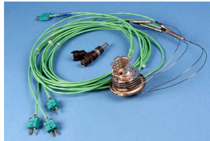
Kühlkörper eines DeNox-Injektors mit Thermoelementen
