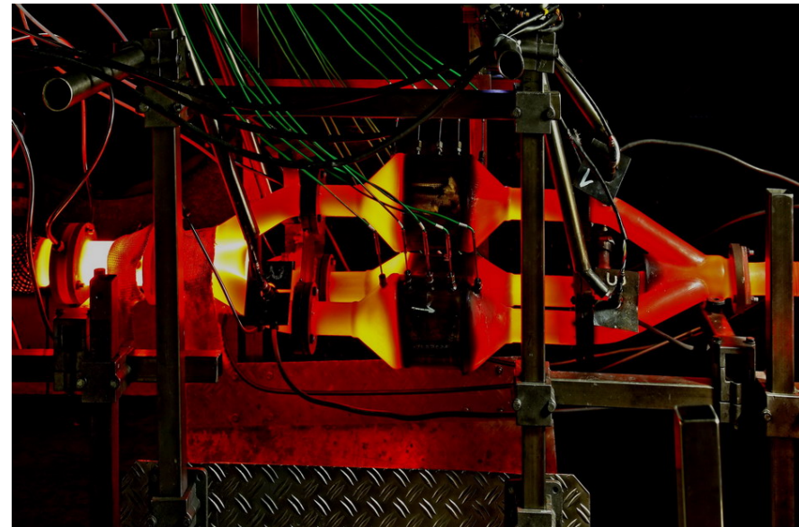
Kat-Alterung mehrerer Prüflinge an einem Abgasstrang
