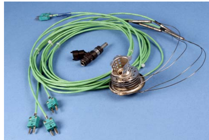
Kühlkörper eines DeNox-Injektors mit Thermoelementen
