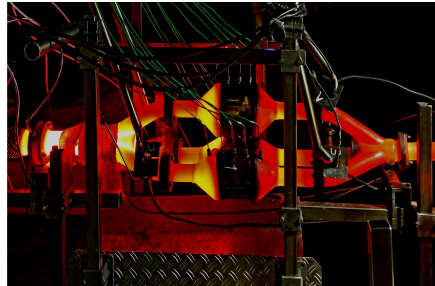
Kat-Alterung mehrerer Prüflinge an einem Abgasstrang
